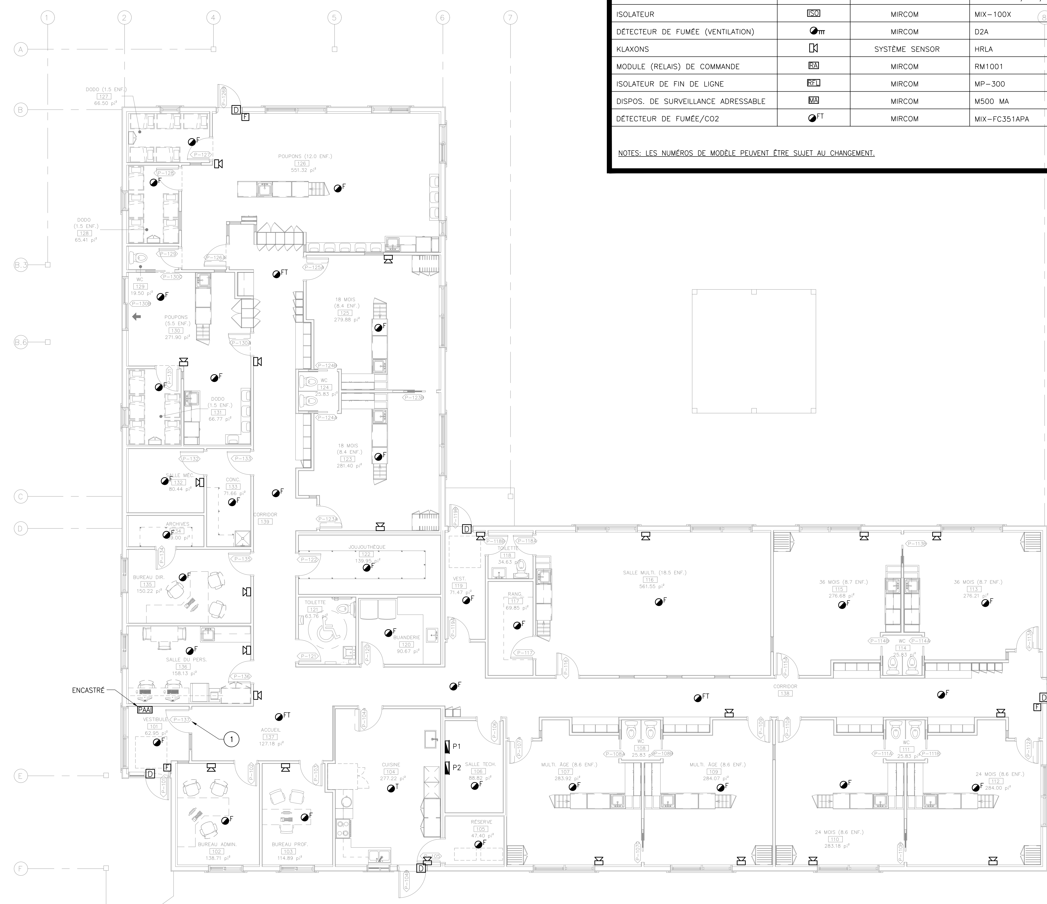
ALARME INCENDIE ET CONTROLE D'ACCES REZ-DE-CHAUSSEE ECHELLE 1/8" = 1'-0"
